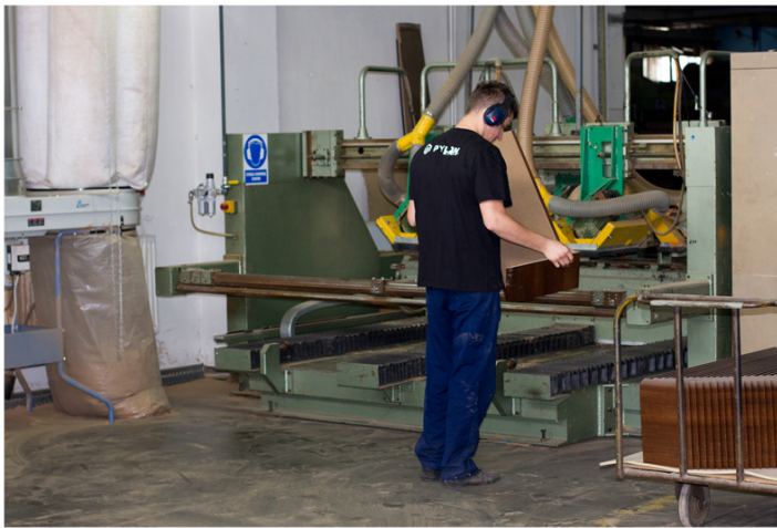
Ukoso, dostosowanie oklejonej formatki pod montaż obudowy.
